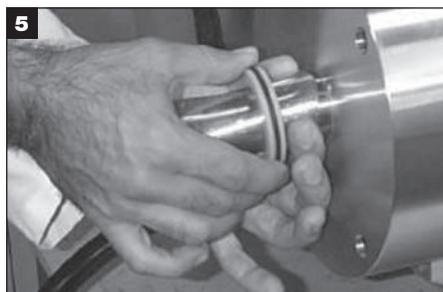
Deslice un extremo sobre el eje abocinando el cilindro formado por el material para calzos sobre el extremo del eje.
