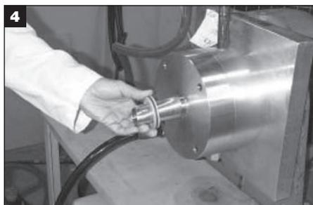
Alinee el extremo del cilindro formado con el material para calzos con el extremo del eje.
