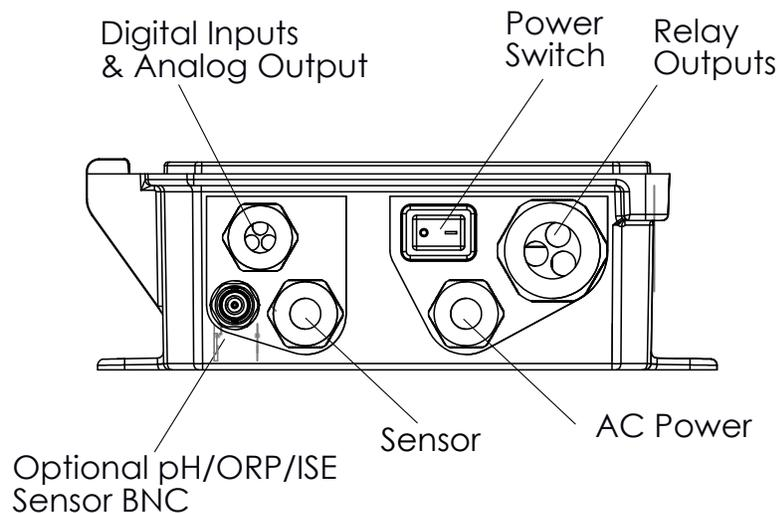
**Figure 1 Conduit Wiring**
