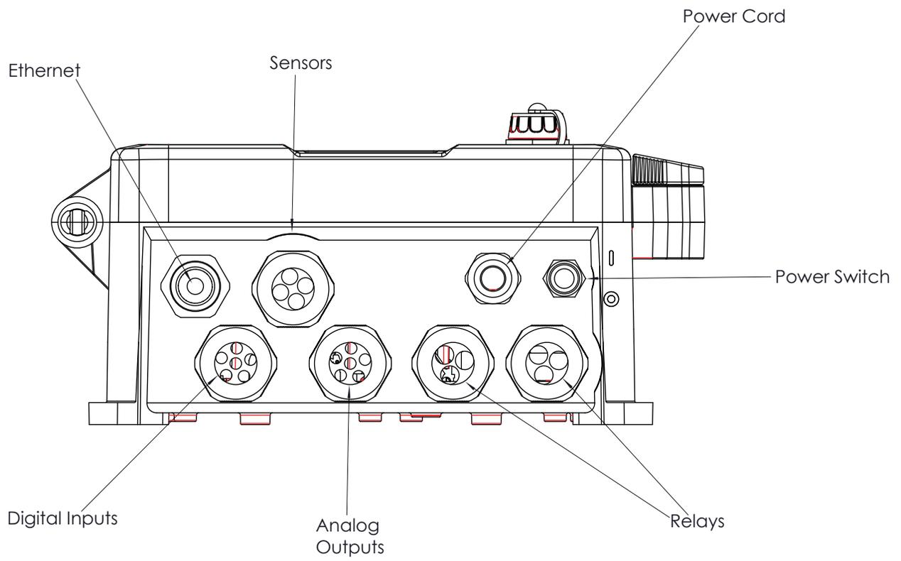
**Figure 5 Conduit Wiring**
