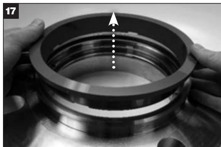
17 Retire el anillo del sello estacionario interno de la brida y deséchelo.
