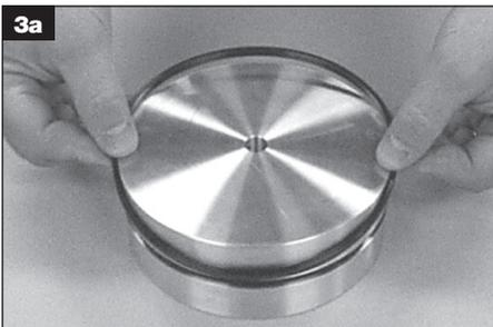
**3a** El anillo para pistones fabricado de material de poliuretano se estira fácilmente.
