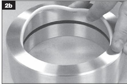
2a y 2b. El anillo para vástagos se coloca en la cavidad del equipo.
