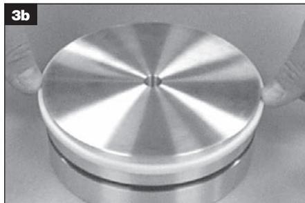
**3b** El anillo para pistones fabricado de material de PTFE modificado deberá estirarse mínimamente para colocarlo en la ranura del equipo. Los materiales de PTFE modificado deberán comprimirse uniformemente en la ranura. Debe tenerse cuidado para evitar un estiramiento variable o un sobreestiramiento.
