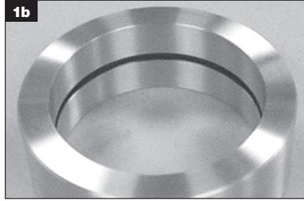
1a y 1b. El O-Ring debe colocarse inicialmente en la ranura del vástago.
