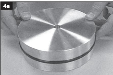
**4a** El anillo para pistones fabricado de materiales de poliuretano se coloca en la ranura del equipo.
