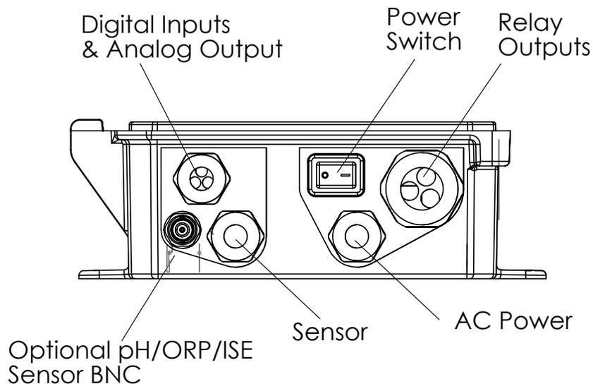
**Figure 1 Conduit Wiring**
